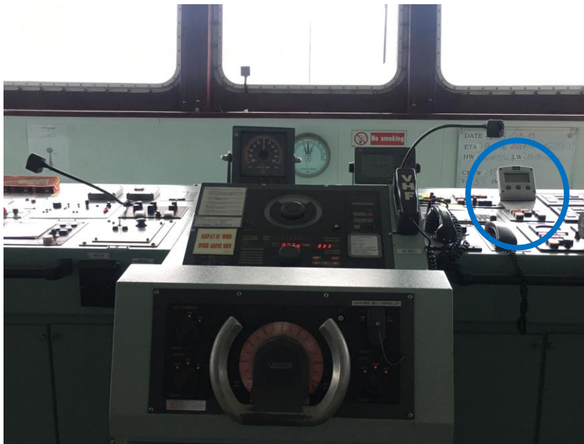
Billede 4: Eksempel på en central placering af brændstofmåler (i den blå cirkel)
